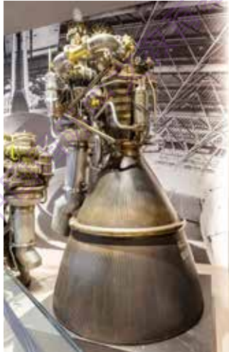
长征系列火箭二级发动机 Motor secundário de foguete da série Longa Marcha
