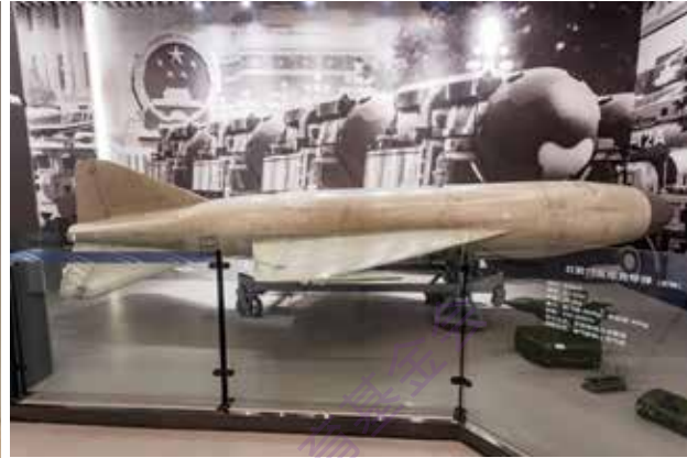
上游一号舰舰导弹： 弹长：6.55 m；弹径：0.76 m；翼展：2.41 m；弹重：2 095 kg Misil antibuque “Shangyou-1”：6,55 m de longitud； 0,76 m de diámetro；2,41 m de envergadura；2.095 kg de peso.
